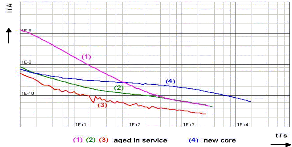
Bild 7 Polarisationsströme baugleicher unterschiedlich gealterter 400 kV Transformatordurchführungen.
