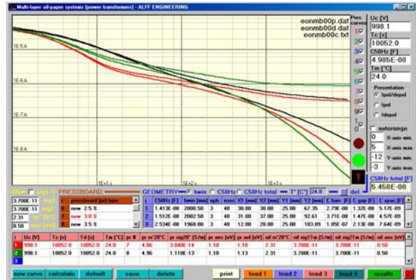
Bild 6 PDC-Analyse eines 300 MVA Transformators durch Kurven-Fitting der gemessenen Polarisations- und Depolarisationsströme (schwarze Kurven).
